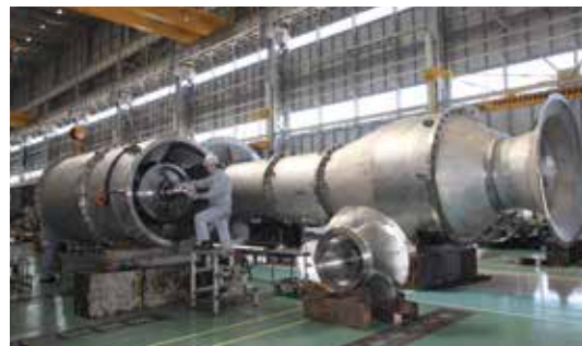
工場棟では、さまざまな種類のポンプを作っています。(海水を真水にかえる機械のポンプ)
