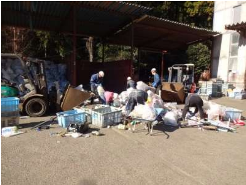
富津市環境センター 不燃ごみ処理状況 (手選別による前処理)
