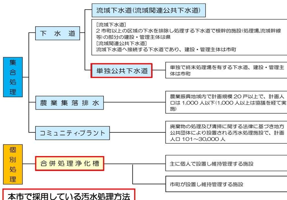
図-1 汚水処理施設の主な整備手法
