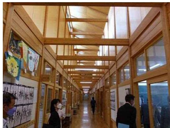
廊下は、構造体の梁が見える構造で、明り取りの窓からの採光がよく開放的。板張りの壁の雰囲気もよい。
