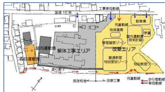
今回工事STEP2 既存校舎解体工事
