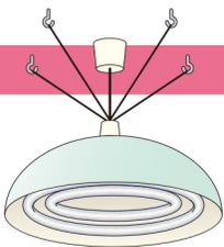
チェーンと金具を使って数箇所止める。蛍光灯は蛍光管の両端を耐熱テープで止めておく。
