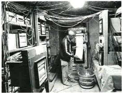
○水晶管伸縮計 熔融水晶によって作られた25mの伸縮計で地殻の伸び縮みを計る
