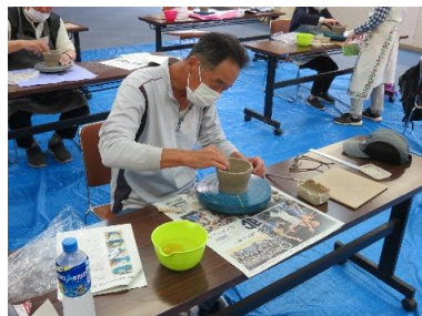
ひもを積みながら成型していきます。
