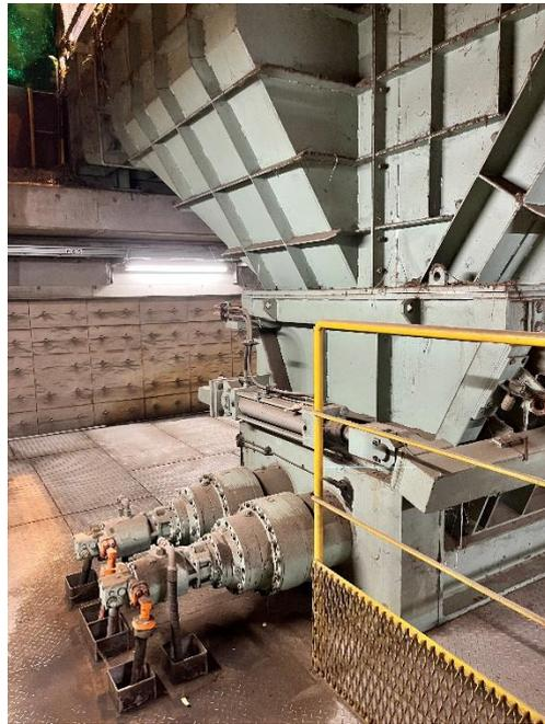
図2-2-1 KCS 低速二軸破碎機
